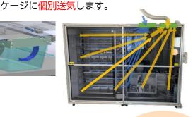
ケージ内に空気を送り込み陽圧環境にします。 装置外部に臭気が漏れないよう装置内は陰圧環境です。 換気量は 15回/1時間を基本に 調整可能です。
